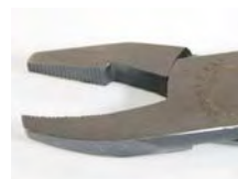
32 125 00 KNIPEX Brech- und Kröselzange, 160 mm Länge, 5 mm Backenbreite, ölgehärtete Backen, ummantelter Griff Breaking and grozing pliers, 160 mm l., 5 mm jaw width oil tempered jaw, coated grip
