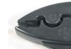
32 140 00 KNIPEX Brechzange, 180 mm, 22 mm Backenbreite, erleichtert das Brechen von schmalen Streifen Breaking pliers, 180 mm, 22 mm jaw width, easy breaking of small strips
