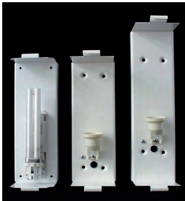
20 276 01 Wandhalter, einflamig, für PL-Technik 5 - 11 Watt, (Lieferung ohne Leuchtmittel), Höhe: 23 cm, Abstand Wand-Glas: 9,5 cm, Wall fixture, 1 - light, for PL technique 5 - 11 watt, (light bulb not included), height: 23 cm, distance wall-glass: 9,5 cm, ( für Formen / molds: 35 228 00, 35 225 61, 35 225 56)
